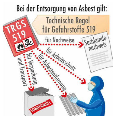
Abb. 2: Regeln zur Entsorgung von Asbest (Quelle: tps://www.sanier.de/entsorgung/asbest-haueufige-fragen )
