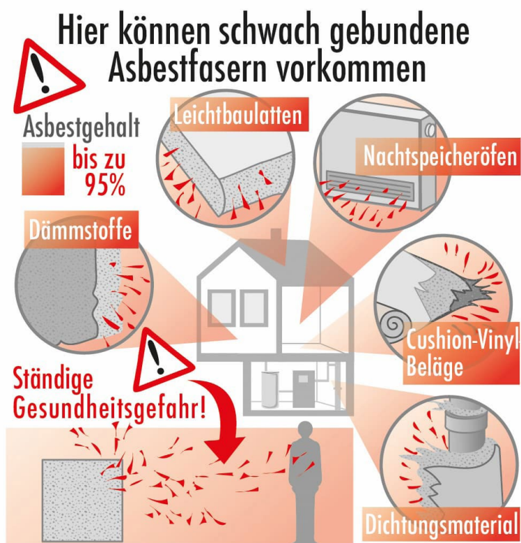
Abb. 1: Augen auf - beim Haus(ver)kauf - mögliche Asbestquellen in Gebäuden (Quelle: https://www.sanier.de/entsorgung/asbest-entsorgen )
