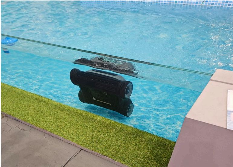
Abb. 9: Aiper Seagull pro bei der Wandreinigung
