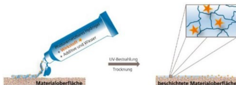
Abb. 2: Ausrüstung einer Materialoberfläche mit Hydrogel und antimikrobiellem Wirkstoff (Quelle: www.igb.fraunhofer.de )
